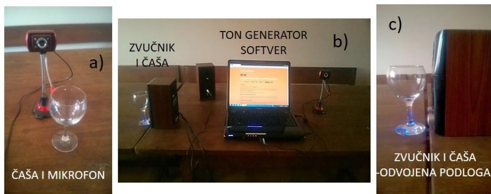
Slika 2. a) Postavka za merenje prirodne frekvencije čaše. b) Postavka za pobuđivanje čaše zvukom. c) Detalj postavke sa slike b) koji pokazuje odvojenu podlogu zvučnika i čaše.
