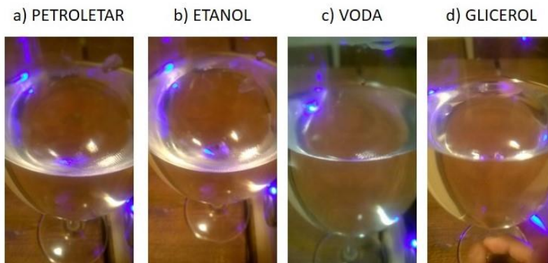
Slika 3. Površine četiri različite tečnosti u rezonirajućoj čaši.
